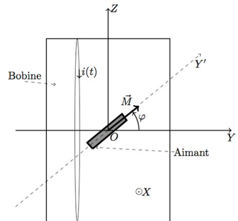
Figure 6 : Schéma de principe d'un alternateur de vélo
